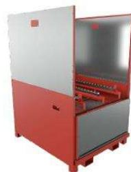
防护装置旨在捕获可燃液体泄漏，以预防扩大火灾规模。275 型和 330 型防护装置的容量可达其型号中体积的 150%，可容纳大部分溢出的可燃液体，因此可防止火势蔓延。限制防护装置表面的大小可以减少火灾的热量释放率，从而减轻空间内的物理损坏。此外，该装置还可容纳位于保护区内喷头或雨淋系统排放的额外的水或泡沫溶液。
