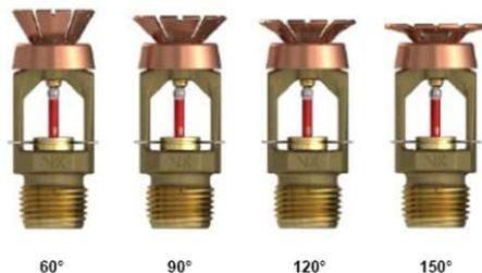
另外该喷头的小框架结构可以容许其被用于拥挤的保护区中,配置的  $\Phi 3\text{mm}$  玻璃泡被完整地包容在框架结构中,可以避免机械的碰撞。在腐蚀性环境中玻璃泡较易溶合金动作元件更有抗腐蚀性。另外,独特的特氟龙涂层更能被用于大多数的腐蚀性环境中。
