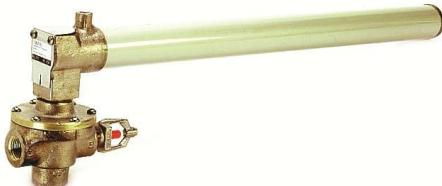
不同来实现开启雨淋阀。该装置同样还装配有一只固定温度动作的喷头,其在固定的温度下卸压启动管网中的压力,而不用考虑温度上升的速率。该装置可被用于室内或室外的气/水压差启动管网。C-1 温差释放装置不应被使用于腐蚀性环境中(当保护区为海水环境时,请参看威景 C-2 温感释放装置的技术资料)。当气压差管网使用氮气时,请选用对应的产品编号。
